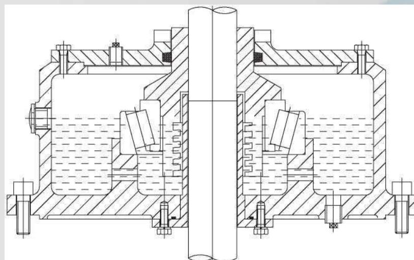
Стандартный вариант узла опорного подшипника
