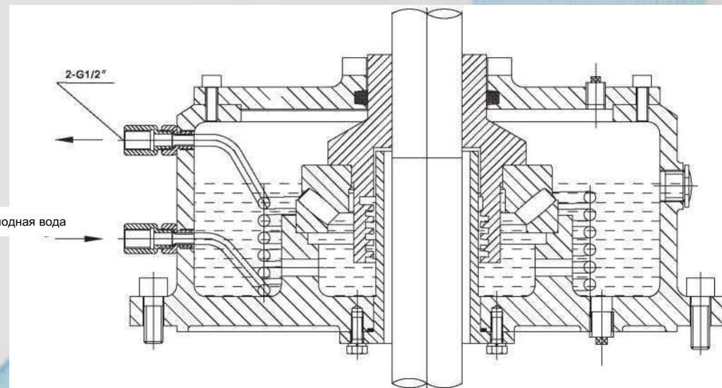
Вариант сверхмощного узла опорного подшипника с водяным охлаждением
