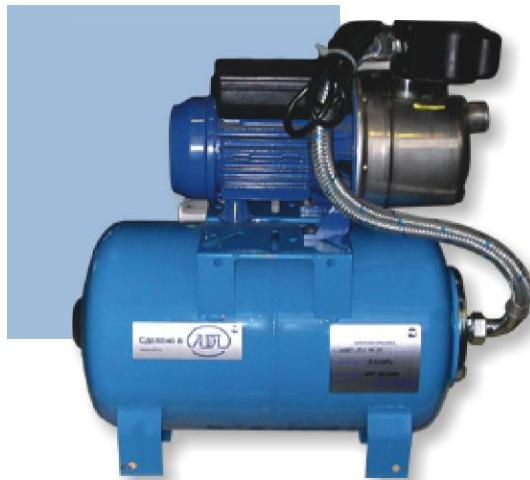
Бытовая насосная установка включает в себя: насос, мембранный бак, регулируемое реле давления, обеспечивающее автоматическую работу установки, манометр для контроля давления в системе, обратный и запорный клапаны. Установки могут поставляться с реле защиты от «сухого хода» и без него.
